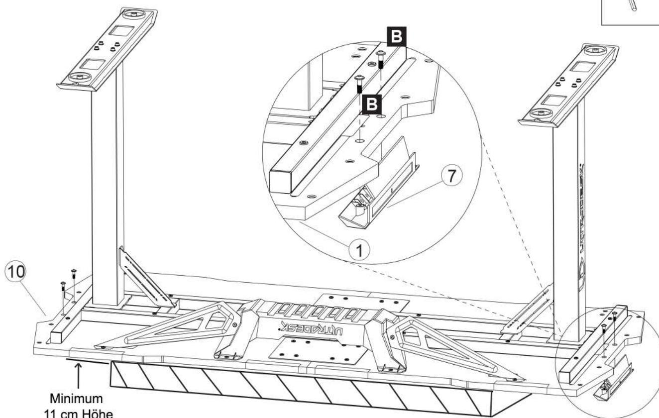
1. Legen Sie die Tischplatte bei der Montage auf mindestens 11 cm Höhe, um Kratzer und Beschädigungen der LED Beleuchtung zu vermeiden.
